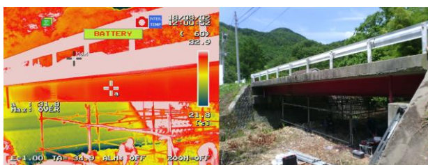
写真-2 赤外線画像と可視画像(試験1日目12時)
