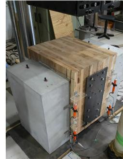
図-1 押し抜き試験の試験体
