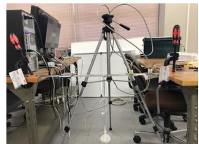
図4 両端固定梁の場合のセンサの設置状況（横からの写真）
