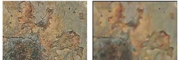
図-1 さび外観評価レベル1
