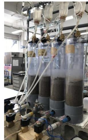
図-1 タイダルフロー人工湿地実験装置の外観
