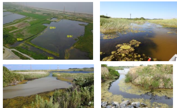
図-3 洲崎湿地の現状 左上：ドローンによる空撮（2017.09.09：阿武隈生物研究会 池田洋二 撮影）。湿地 A-B、B-D、A-C 地点間は人工的な溝が形成されている。夏季の調査時は、植生の繁茂や地点 C の水深が浅い場所があり、ボートでの観測が困難を伴う。右上：A 地点では、表層は透明度があるが下層は茶色の懸濁物があり、すぐに巻き上がる。その境界には塩分濃度の急変部があり明確な密度躍層が形成されている。左下：B 地点では、強風時に吹送流によると思われる濁りが発生した（2017.09.03）。右下：A 地点から潜ヶ浦水道に排水される人工排水路部。水質鉛直分布の測定地点。湿地植物・抽水性植物・浮遊植物などが存在する（未同定）。
