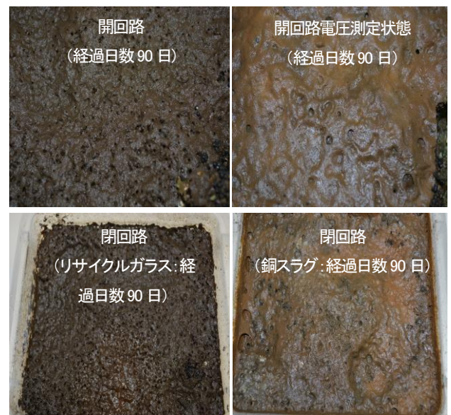
図-4 開回路、開回路電圧測定状態、開回路(リサイクルガラス)及び開回路(銅スラグ)の堆積物表面の様子
