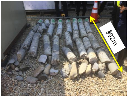
図-4 先行ボーリングのコア抜き
