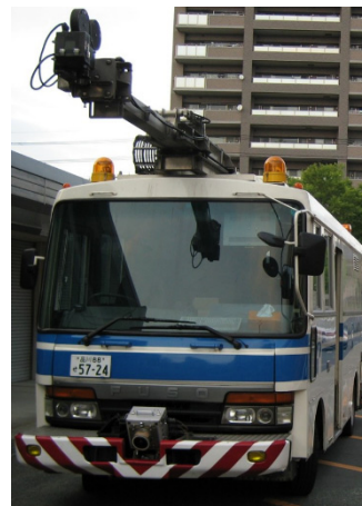
図-2 路面計測車
