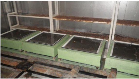
写真-1 凍結融解試験状況
