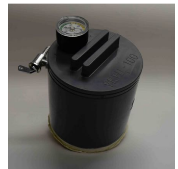
写真-2 簡易透気試験器
