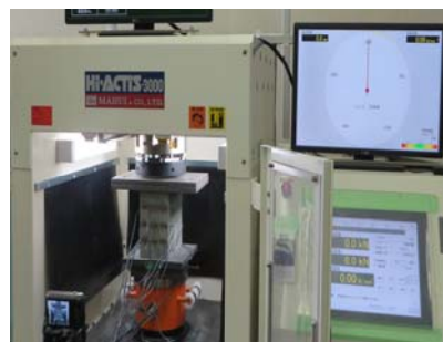
写真-2 圧縮試験機および試験体設置状況(3_00_N)
