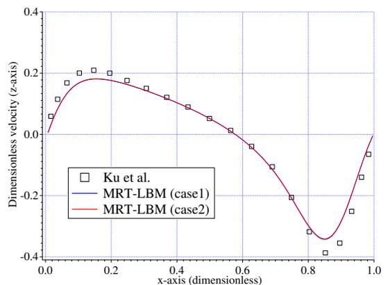
図-4  $z$ 軸方向に対する流速の空間分布
