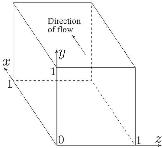
図-2 Ku et al.(1987)による3次元キャビティ流れの計算体系
