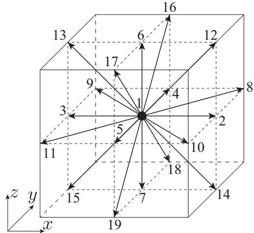
図-1 3次元19方向型格子形状
