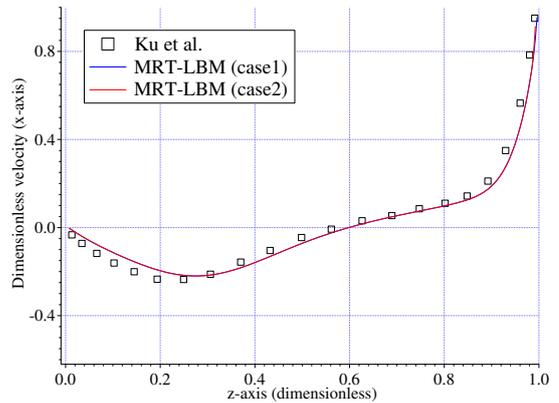
図-3  $x$ 軸方向に対する流速の空間分布
