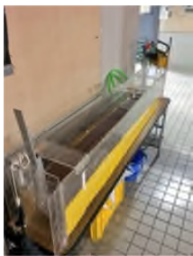
図-4 津波発生装置(斜め上から)
