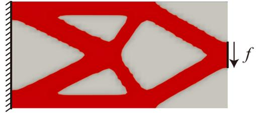
図-1 静的荷重を受ける片持梁の最適化結果（剛性最大化）
