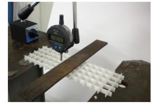
図-7 曲げ試験 (ハニカム板) 図-8 曲げ試験 (格子板)
