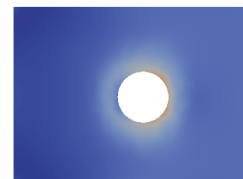
図-10 母材のミーゼス応力（母材がボルトに接触かつ滑りなし）
