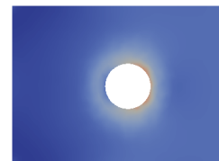
図-9 母材のミーゼス応力（母材がボルトに接触かつ軸力のみ）
