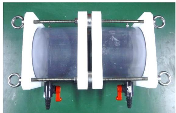
図 1 本実験で使用した拡散セル
