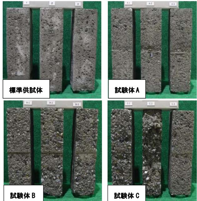
写真-1 外観状況「240サイクル(比較試験体 A~C)」
