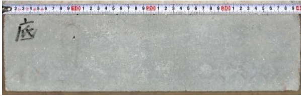
写真-1. (a) 外観性状（600 °C 加熱のみ）
