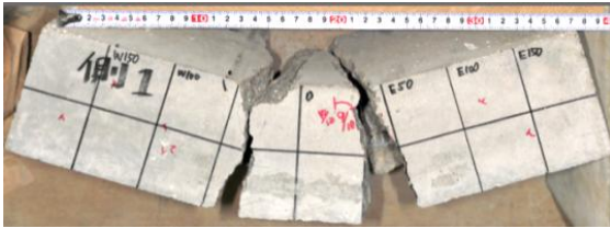
写真-3. (a) 破壊形態（600 °C 加熱 + 塩水）
