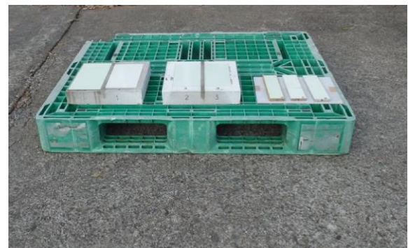
写真-3 蓄光タイルの暴露試験状況(屋外)
