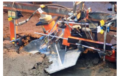
写真-1 ロッキング破壊の状況
