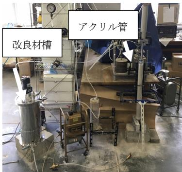
図-1 一次元浸透試験機
