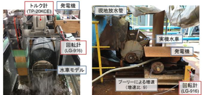
図1 水力発電装置(左:水車モデル、右:実機水車)
