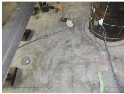
写真-1 試験体IIIの破壊状況
