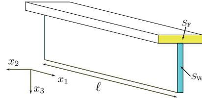
図-1 解析対象の梁とその断面
