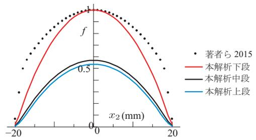
図-3 セン断遅れによる変位分布  $f(x_2, x_3)$
