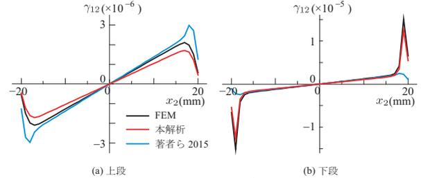
図-4 上フランジのせん断ひずみ ( $x_1 = -100 \text{ mm}$ )
