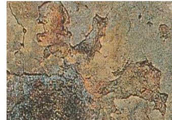
図-1 さび外観評価レベル1
