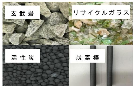
写真-1 実験装置の構築材料
