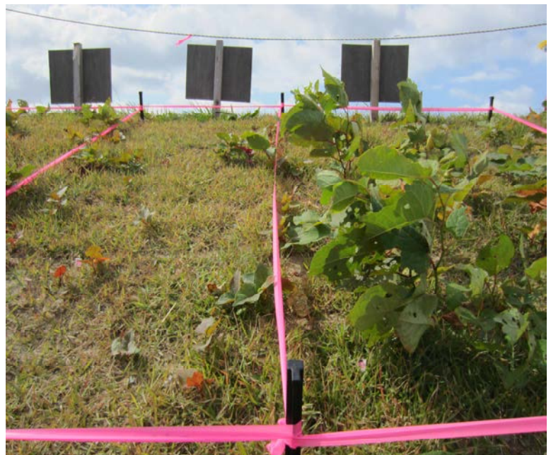
【写真-6】 施工後2ヶ月目の状態。左は網を敷いた部分で右は通常のもののイタドリの成育状況の違いが明確である。
