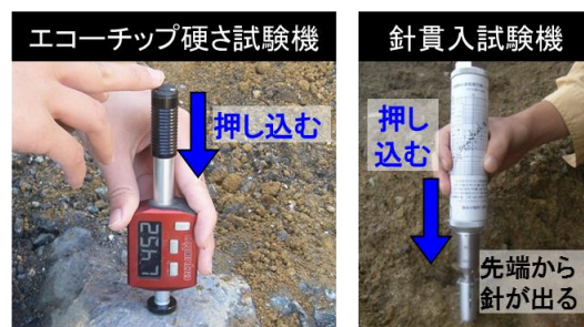
写真-1 エコーチップと針貫入試験機
