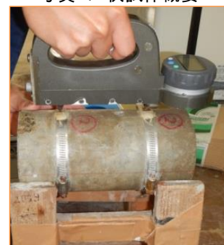
写真-2 コンタクトゲージ法
