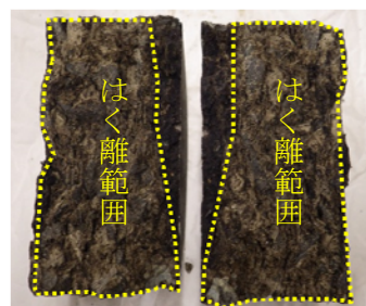
図4 標準圧裂試験後破断面 (37年経過した基層)
