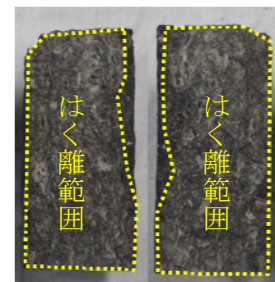
図4 標準圧裂試験後破断面 (37年経過した基層)
