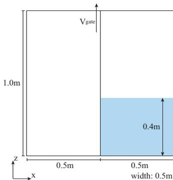
図-3 ゲート急開流れの実験模式図
