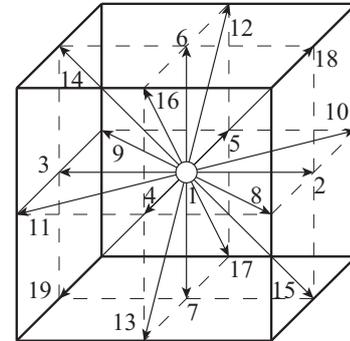
図-1 3次元19方向型格子形状
