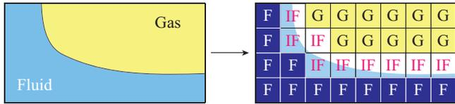
図-2 自由表面のモデル化
