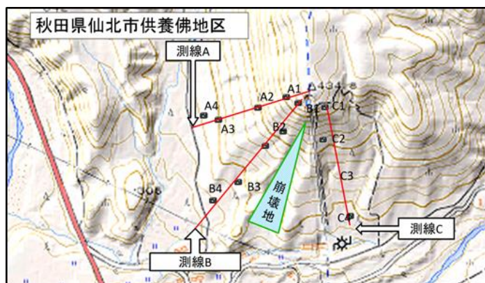
図 1：地盤に関する調査の試験箇所
