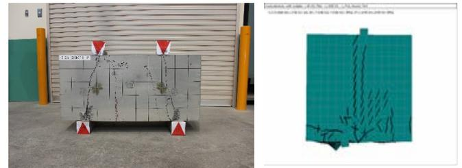
図 6 PBL 有モデルの最大荷重時ひび割れ状況
