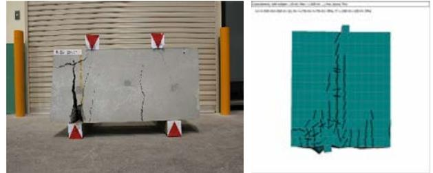
図 5 PBL 用いていないモデルの最大荷重時ひび割れ状況
