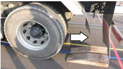
写真-1 踏み台落下試験状況
