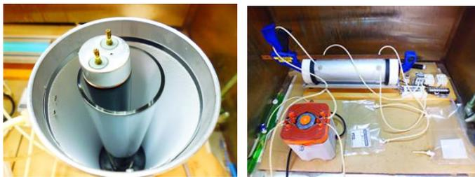
図-1 装置内部(左図)と光触媒反応装置(右図)
