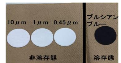
図-2 <sup>137</sup>Cs の濃縮と溶存・非溶存態の分離に用いたディスク
