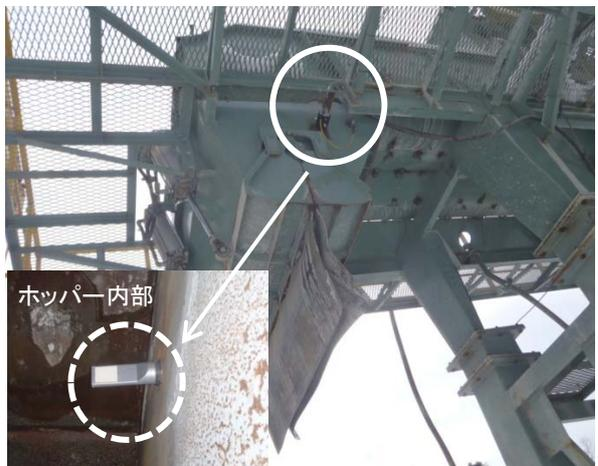
写真-2 マイクロ波水分計設置箇所
