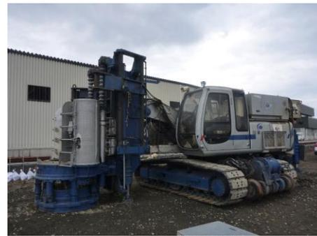
図4-1 低空頭型鋼管杭回転圧入工法に用いる杭打ち機
