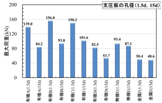
図-4 支圧板の孔径 1.5d と 15d の最大荷重
