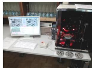
図-1 気泡計測装置
