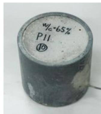
写真-1 実験供試体
