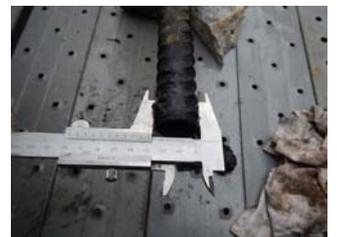
写真2 アンカー破断部状況
