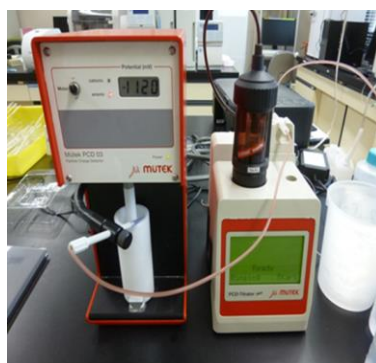
PCD 03 PCD-Ttwo 図 1 粒子電荷計 PCD03 と自動滴定ユニット PCD-Ttwo
