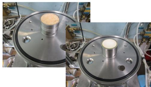
写真1 ポーラスストーン（左）とセラミックディスク（右）
