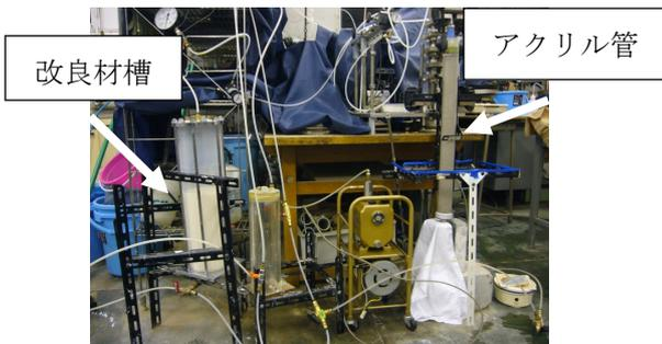
図-1 一次元浸透試験機
