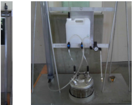
図-1 供試体と圧入装置
