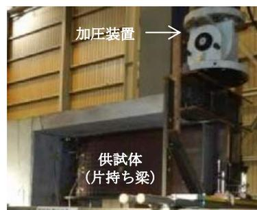
写真-1 荷重载荷システム
