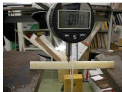
図-5 曲げ試験体
